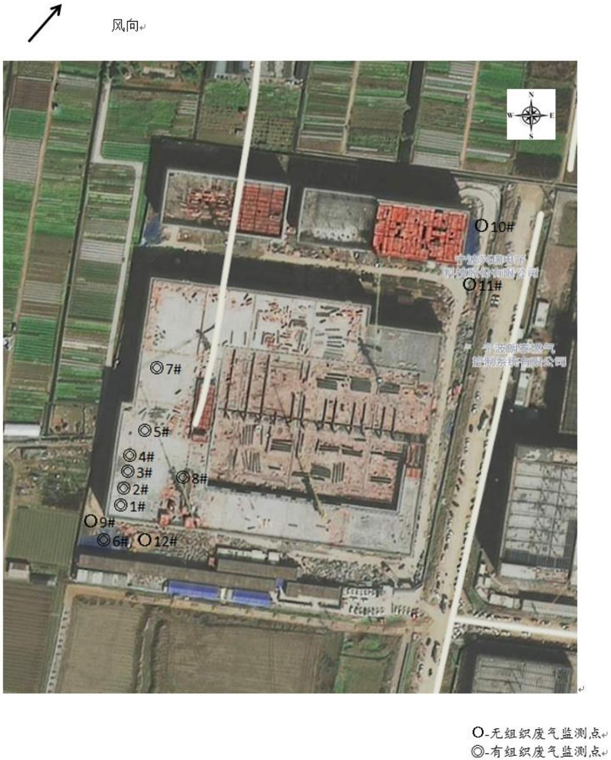
图 7.1-1 废气监测点位布置图
