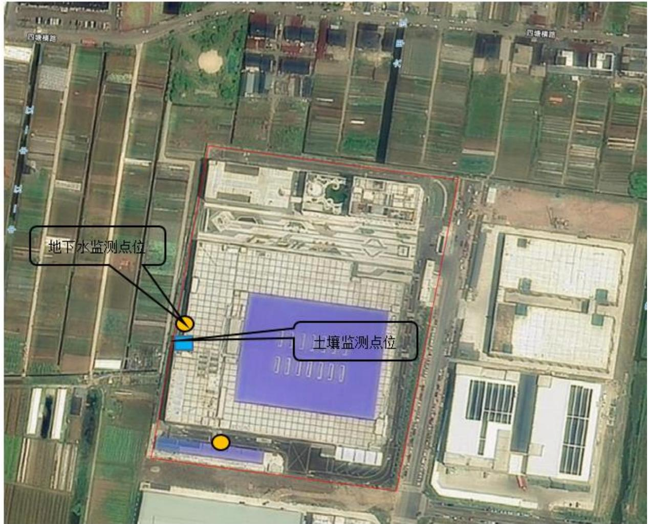
图 7.2-2 地下水、土壤监测点位示意图
